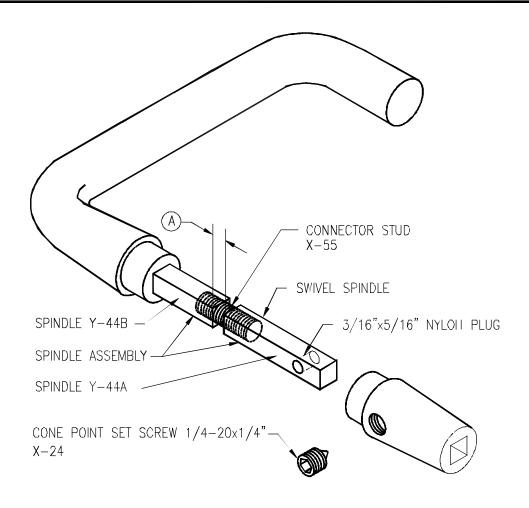
(A) NOTE: BACK OFF SPINDLE TO SUIT DOOR THICKNESS
